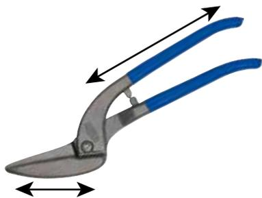
Обычные ножницы для резки листового металла традиционно имеют цельнокованые лезвие и рукоятку. Усилие резания зависит от соотношения длины лезвия и длины рукоятки.
