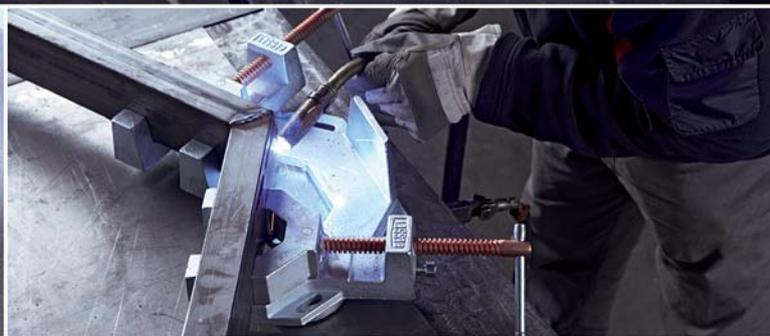
Свободный доступ к детали при сварочных и монтажных работах
