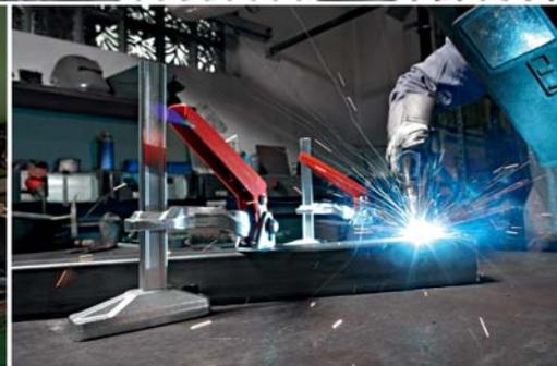
Быстро и надежно зафиксировать деталь на механизмах и станочных столах
