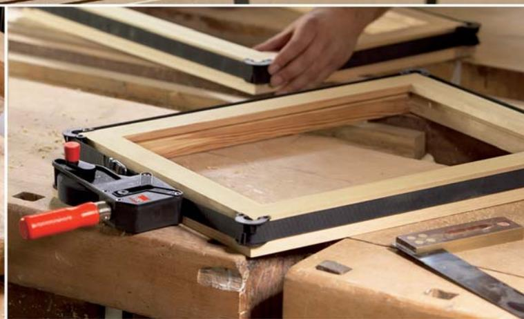
**Двусторонний равномерный зажим без перекоса**
